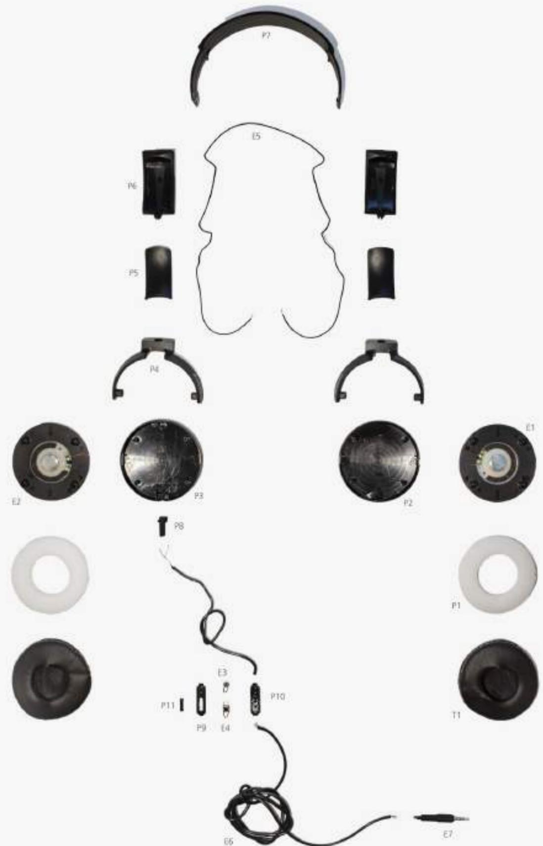
modo, per far arrivare il ground al lato destro, viene aggiunto un cavo che unisce i due driver, passando sempre all'interno dell'archetto. Al connettore jack sono anche collegati il microfono e il pulsante che lo controlla, entrambi i quali si trovano all'interno della scocca collocata lungo il cavo che dal padiglione sinistro arriva appunto al connettore a quattro poli.
