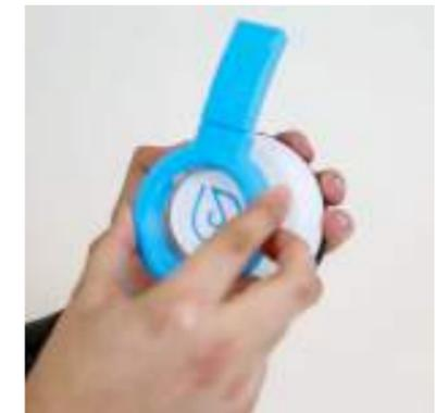
Disassemblaggio a incastro;
