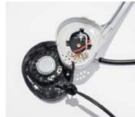
Driver, nel padiglione destro, collegato al braccetto del microfono
