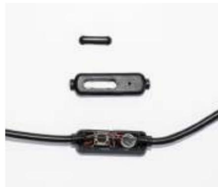
Disassemblaggio dell'unità collocata lungo il cavo
